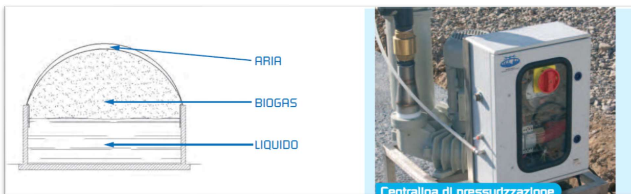
Figura 2.3 - Centralina di pompaggio aria e schema membrane
